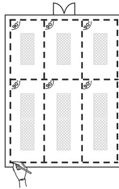
Fig. 6 Installation autour d'objets fixes – procédure de pose des dalles
